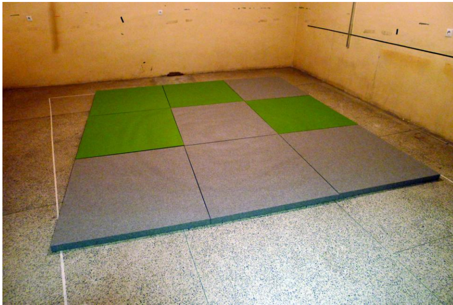
Rysunek 1 Widok próbki zamontowanej w komorze pogłosowej
